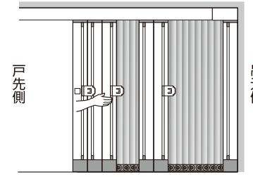
網戸を開けるときは戸先側のスライドバーを押すようにして開けホールドフックを収納枠に引っ掛けて下さい。網戸の操作は、スライドバーの中央部で行います。極端な位置で操作しようとすると操作性が悪くなる場合があります。
