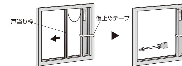
④仮止めテープを外し網戸を20~30cmほど開きます。収納枠をタッピングネジで固定します。ワイヤー調整ネジに触れないようご注意ください。
