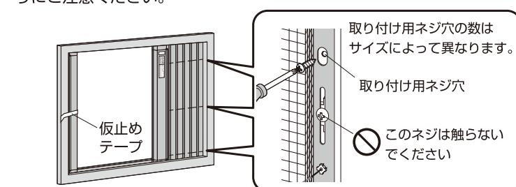
④ワイヤースッパーをワイヤーの上から下枠の中心に取り付けます。
