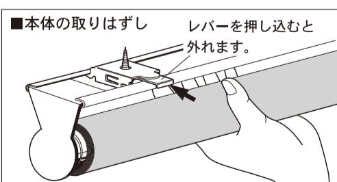
マウントベースごと取付位置に押しつけます。仮止めテープがはがれないようにマウントベースをマウントブラケットメタルから取りはずします。右の図のように本体を取りはずし、ネジでマウントブラケットメタルを固定します。
