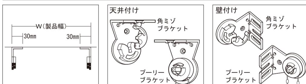
ブラケットを上図のように製品幅と同じ位置に取り付けます。
