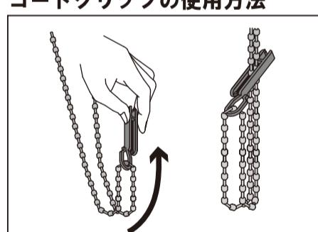
クリップ部を指でつまむとクリップが開閉します。
