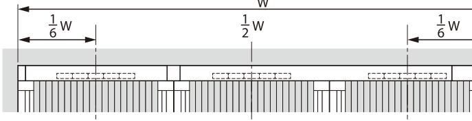
④ブラシストッパー各組の両端にブラシストッパーを貼り付け、下がり止めブラシを固定します。
