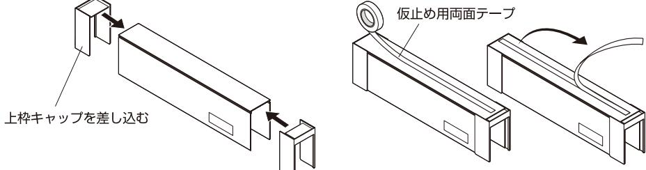
③取り付け位置の中央に上枠を合わせて、左右の隙間が均等になるように天井面に両面テープで仮止めします。
