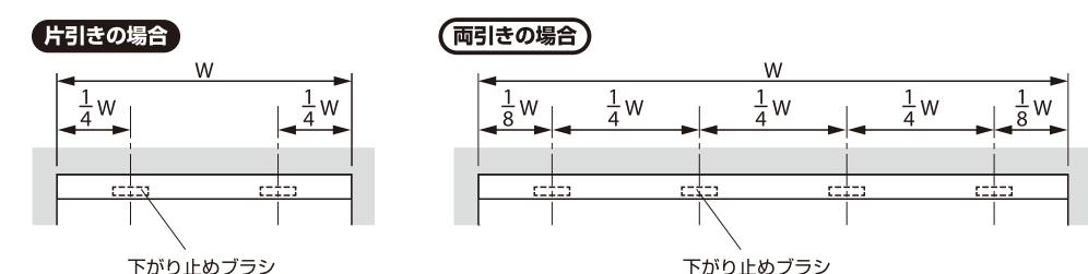
③ブラシストッパーの剥離紙をはがし、下がり止めブラシの両端に貼り付けて固定します。
