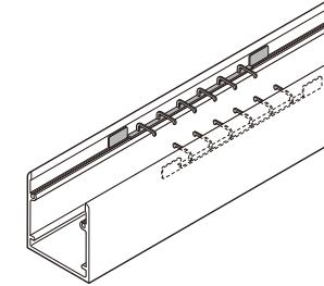
⑥上枠を上枠・アンカープレート取付用タッピンネジで固定します。このとき上枠が変形するまでタッピンネジを締めないでください。
