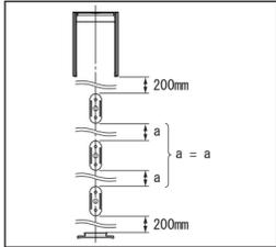
③12-①で引いた線上に、上枠とレール各々 200mm 離れた箇所にアンカープレートの取り付け位置の印をつけます。残りのアンカープレートは等間隔の箇所に印をつけます。
