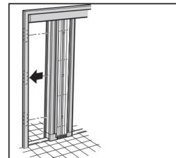
④網戸本体の下側がレールから浮かないようにしながら収納枠をアンカープレートの突起に合わせてパチッと音がするまで押し付けるとはまって固定されます。
