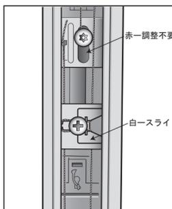
③スライドバーの傾きを調整するねじの位置を確認します。
