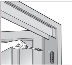
④印の位置にアンカープレートの剥離紙をはがして仮止めします。
