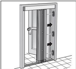
⑥網戸本体の取付時と同じ要領で本体がレールから浮かないように注意しながら収納枠をアンカープレートの突起に合わせて押し付けるとはまって固定されます。11. に続きます。
